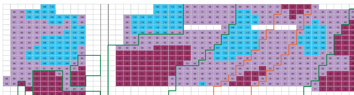
図-2 不同沈下シミュレーション結果（供用開始から2.5年間、平均値）
