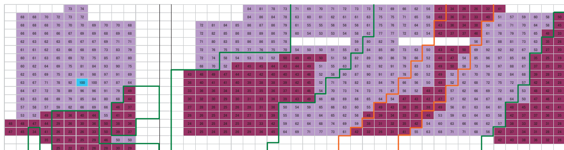
図-2 不同沈下シミュレーション結果（供用開始から1.5年間、平均値）
