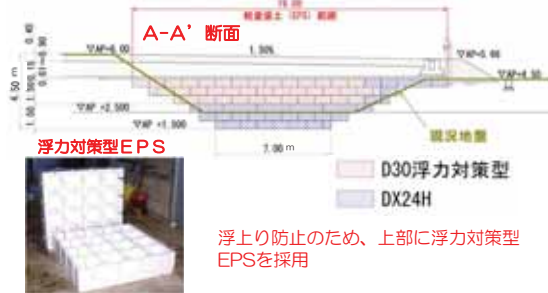
図-2 EPS断面図
