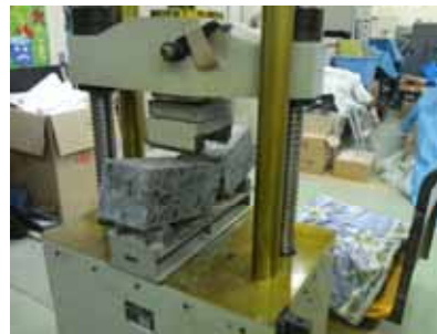
④ 曲げ強度試験実施状況
