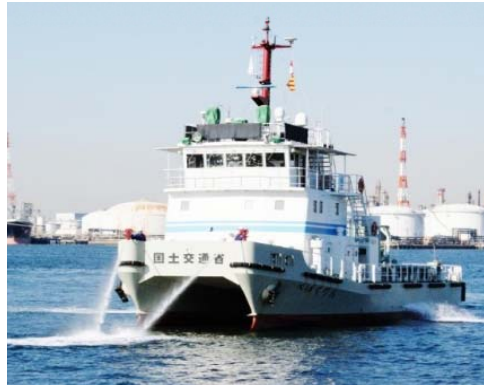
◆浮遊油を拡散し航路啓開する訓練(東扇島)
