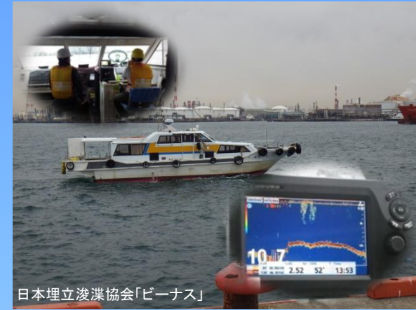
船舶搭載ソナーによる物資輸送岸壁の海底障害物等調査訓練
